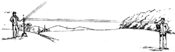
FIGURA 2. Fotófono construido por A G Bell según un dibujo de la época (encima) y esquemas hechos por el propio Bell, quien intentaba transmitir la voz utilizando un haz modulado de luz.
