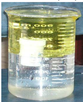
FIGURA 3. El frasco se levanta en el agua debido a la presencia del aceite.
